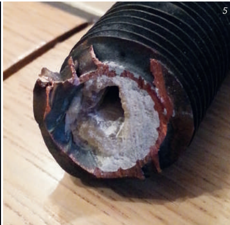
1) verblocktes Edelstahlrohr, 2) verzinktes Rohr, 3) Warmwasserspeicher, 4) verkalkter Plattenwärmetauscher, 5) Kupferrohr eines Wärmetauschers im Warmwasserbereiter, 6) verblocktes Kunststoffrohr
